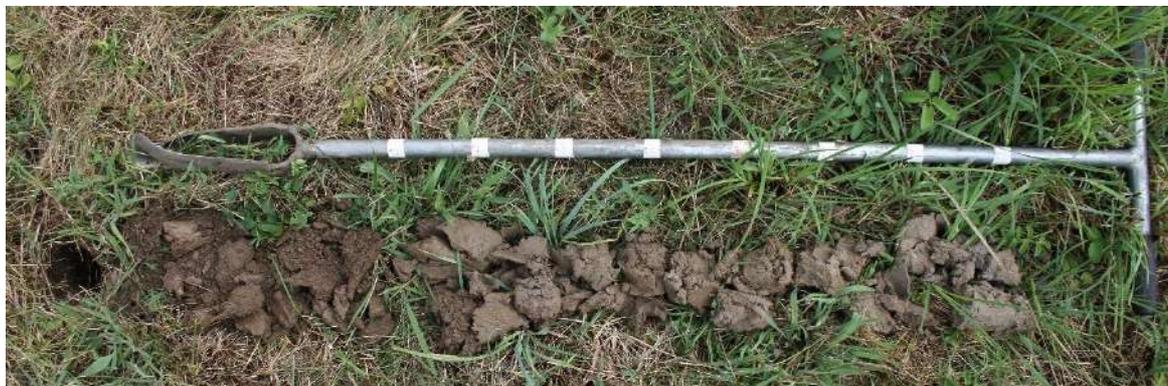
Figure 24 : Observation pédologique à l'aide de la tarière : Carotte de sol étalée de façon à caractériser les différents horizons. Crédit photo : Marine Pouvreau.
