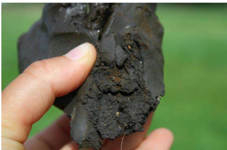
Figure 55 : exemple de l'horizon Gh à 50 cm, argile gris noir plastique avec des taches rouilles d'hydromorphie.
