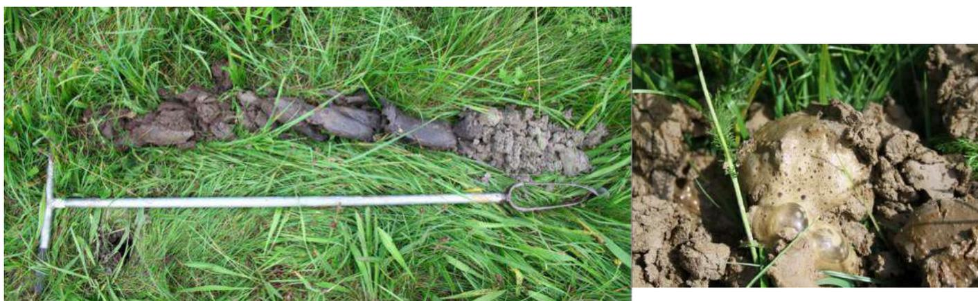
Figure 57: Exemple de sol Limon argilo-sableux, peu hydromorphe (à gauche) et l'effervescence à l'acide typique d'un horizon calcaire à calcique des alluvions du Rhin (à droite).
